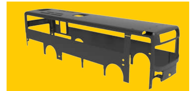
탄소복합소재(CFRP) 차체 (* 철의 9배 이상 강도)
