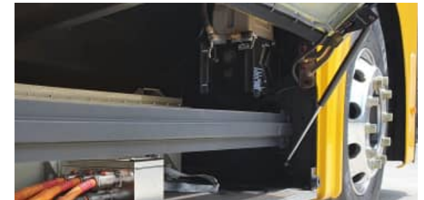
승객석 사이드 정비 도어 & 자동그리스 시스템
